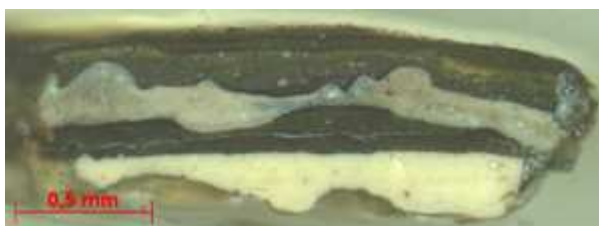
Afb. 62, sample nr. 25_1 voor identificatie van materiaal en opbouw De Charge , linksboven genomen
