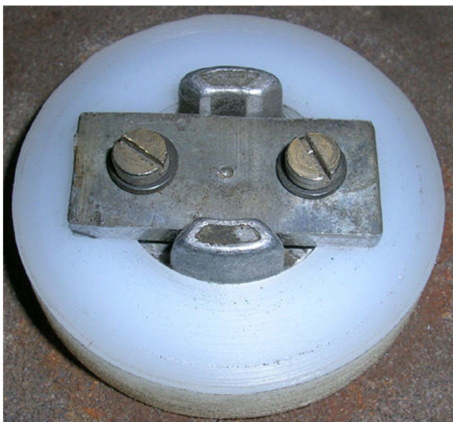
Een aanpassing stukje draaien uit Nylon om de slijpsteen vast te zetten.
