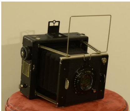
Sport 1930-1939 - Platencamera voor journalisten. Platen van 9x12. Sportzoeker. Ook hier een gordijnsluiters met belichtingstijden tot 1/1000 seconde.
