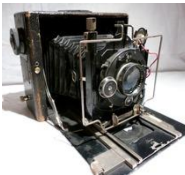
Zweiverschluß Duplex 1927-1939 - met zowel centraal- als gordijnsluiters Vooral voor (semi)professionals.
