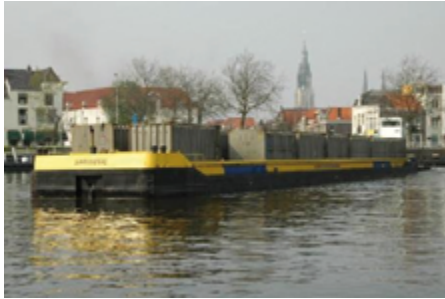
FIGUUR 9: AFVALMANAGEMENT ANNO 2014: DE LAAKHAVEN, EEN VRACHTDUWBAK UIT 1997 MET EEN LENGTE VAN BIJNA 55 METER EN EEN LAADVERMOGEN VAN 640 TON. HAAGS AFVAL VAART DOOR DELFT. (BRON: DE BINNENVAART)
